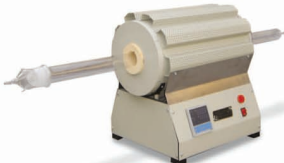
کوره‌ی لوله‌ای افقی با لوله‌ی کوارتز آب بندی شده.
