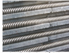
جوارهای نگهدارندهی المنت از جنس گریید سیلیسیم
