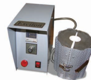
کوره‌ی لوله‌ای عمودی پله‌ای با منطقه داغ به ارتفاع ۵۰ cm.
