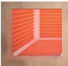
شکل ۷- همدمایی الفت و دیواره در یک کوره دارای لایه ی نسوز اول SIC، چند ثانیه پس از باز شدن درب.
