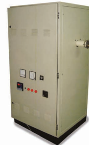
کوره‌ی لوله‌ای افقی ۱۵۰۰ °C دارای لوله آلومینیومی آب‌بندی شده.
