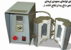
کوره‌ی لوله‌ای عمودی پله‌ای با منطقه داغ به ارتفاع ۵۰ cm.
