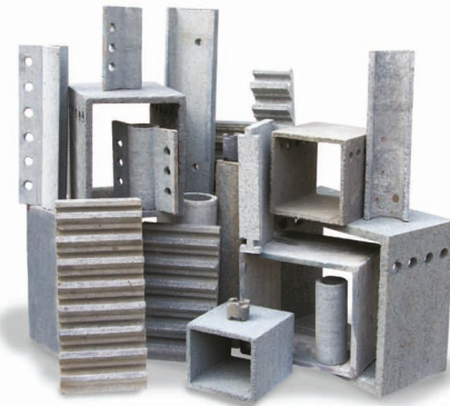
شکل ۳- تصاویر بوردهای ساخته شده از کمپوزیت SiC-Al 2 O 3 مورد استفاده در محصولات اکسایتون.
