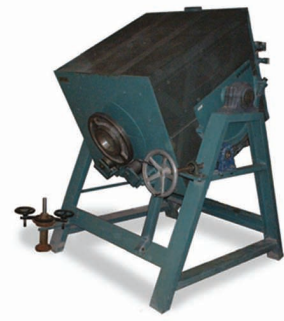
کوره‌ی کریور ایزینگ در حال خمش برای تخلیه قطعات به حمام کوپچ.
