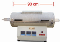
کوره‌ی لوله‌ای افقی پله‌ای دارای سه منطقه داغ مستقل با لولمی گوارتر از آب‌بندی شده.
